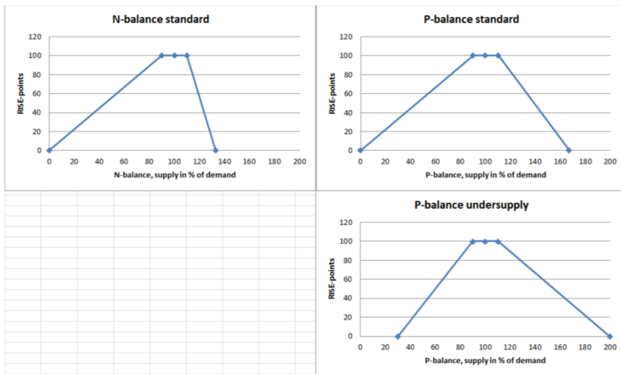
Figur 14. Standard bedømmelses sammenhænge for kvælstof balance (venstre) og fosfor balance (højre). Basis indikatorer for kvælstof og fosfor er baseret på regionale oplysninger.
