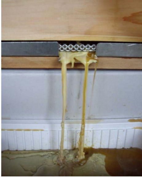
Figur 7. Opsamling af varm voks fra en damp Slyng.
