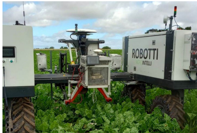
Figur 1. Dataindsamling i sukkerroer med markrobot. RGB kamera monteret på 3-punktsophæng. Foto: Tim Nellemann Bak.
